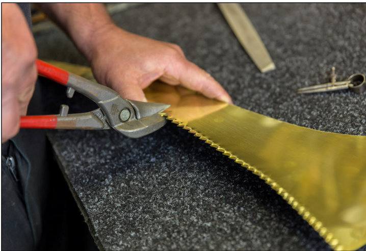
Abb 3. Mit dem Zirkel eine Abstandslinie ca. 4mm vom Rand markieren und „Zähne“ bis zu dieser Markierung einschneiden. Die Lotnaht ist später sichtbar, daher sind gleichmäßige „Zähne“ wichtig
