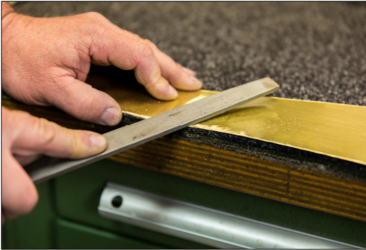
Abb 2. Eine „Phase“ am Zuschnitt des Schallstücks an beiden Seiten der späteren Verzahnung feilen. Ca.4mm breit
