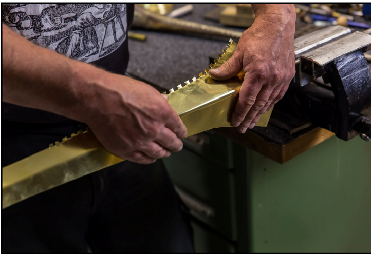
Abb 5. Den Zuschnitt über eine Stange an der gedachten Mittellinie biegen. Achtung, scharfe Kanten und Zähne, Verletzungsgefahr! Fig 5. The bell piece is bent over a steel mandrel. The teeth and the edges of the bell piece are very sharp!
