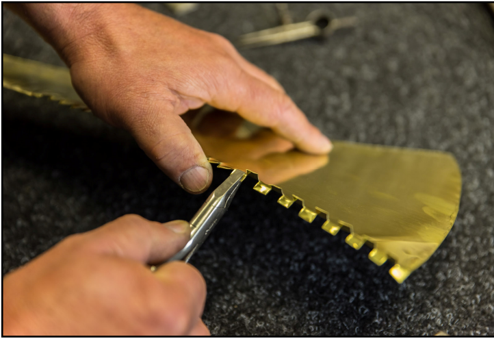
Abb 4. Die „Zähne“ abwechselnd in V-Form mit einer Zange auseinander biegen Fig 4. The teeth are bent inwards and outwards in a V-shape with pliers
