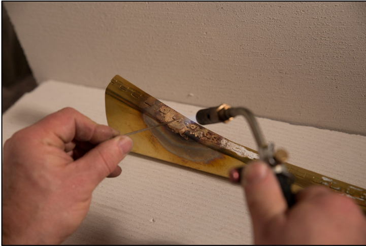
Abb 8. Flussmittel „Borax“ zum Hartlöten auf die Naht auftragen. Mit Silberlot die Lotnaht löten. Wichtig ist ein gleichmäßiger Fluß des Silberlotes, damit keine Löcher in der Naht bleiben, bzw. die „Zähne“ sich später nicht öffnen Fig 8. The seam is coated with borax flux and silver soldered. The solder is very fluid, so to ensure that it flows completely and that there are no gaps that might appear later, it is important to make the seam very tight
